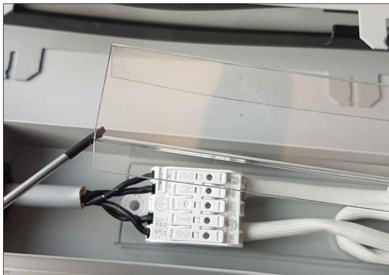
6) Drähte primärseitig mit geeignetem Werkzeug lösen
