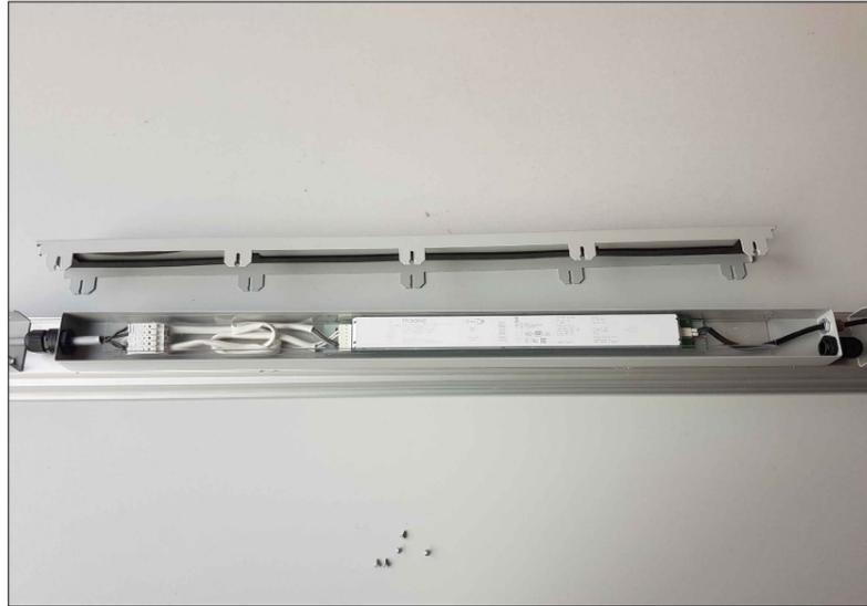
14) Abdeckung mit Druck aufsetzen und von der mitte aus verschrauben
