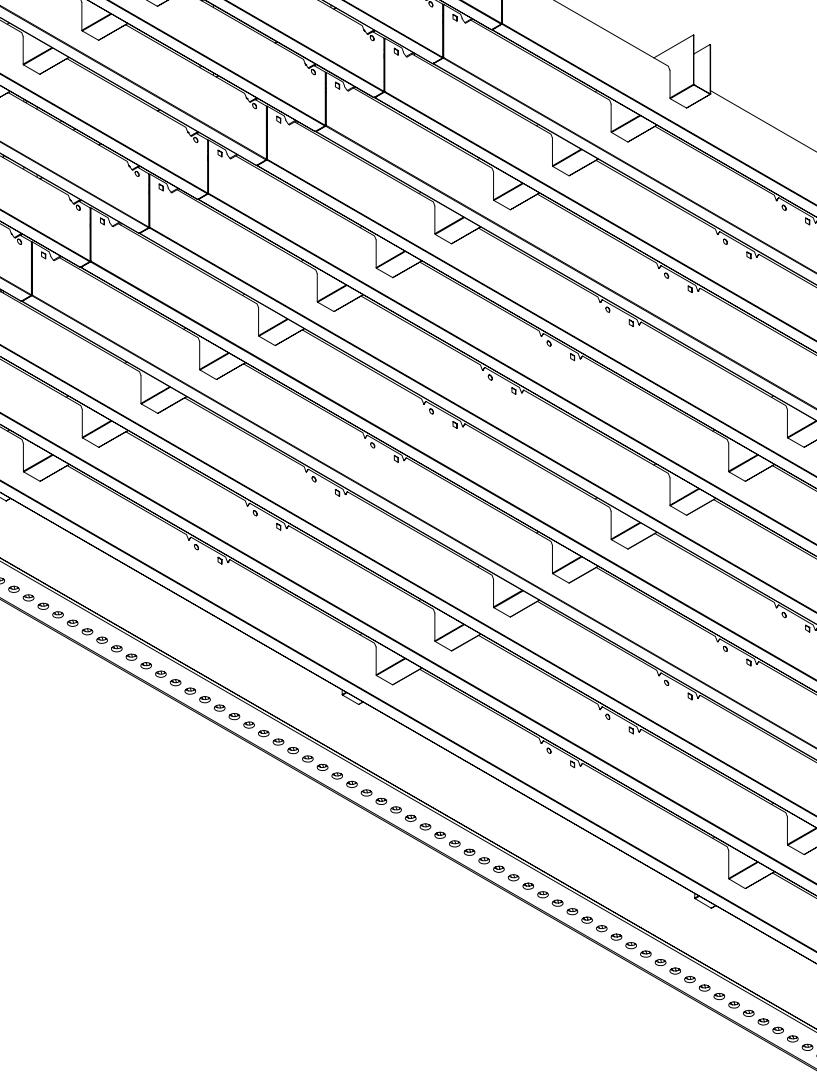
STARLAM 9 COOLTEC ist ein offenes, dekoratives Deckensystem mit einem einzigartigen Erscheinungsbild. Die Oberflächentemperatur des Rasters kann mithilfe der in die Lamellen integrierten Kühllemente aus Kupferrohr und dem darin durchströmenden temperierten Wasser reguliert werden, so dass mit STARLAM 9 COOLTEC Räume, lautlos, zugfrei und hygienisch klimatisiert werden können.
